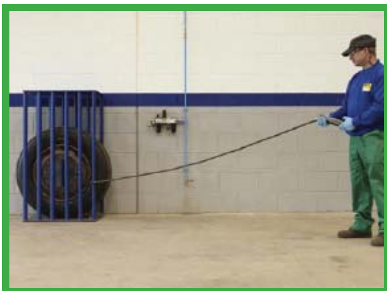
Przykłady zabezpieczeń opony przed rozerwaniem.
