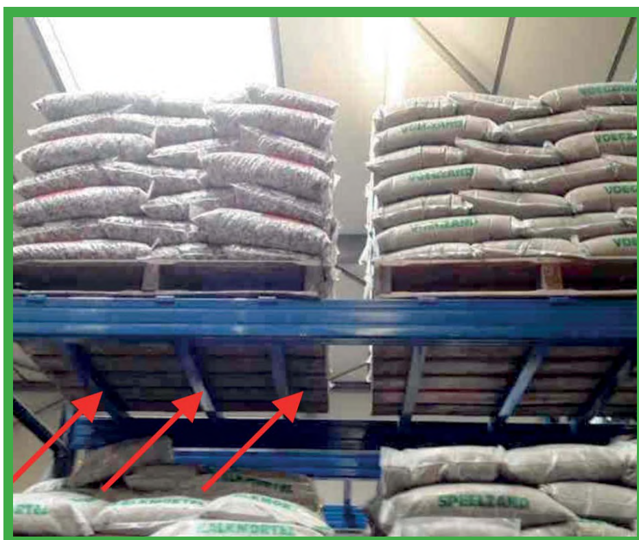
3 podpierające belki w regałach do składowania palet.
