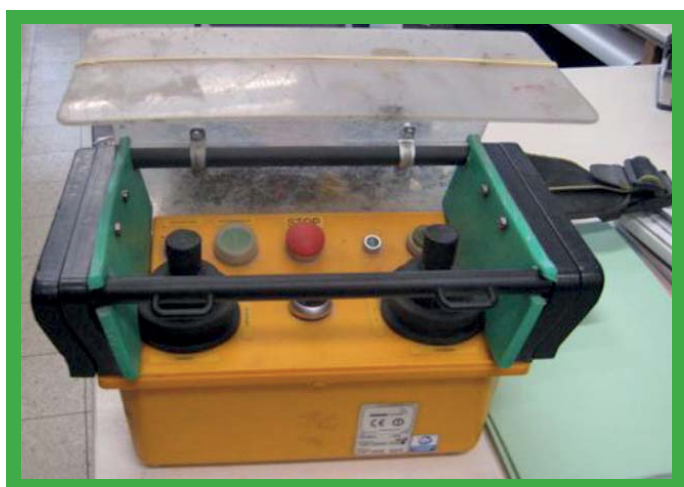
Kasety sterownicze z mechanizmem zabezpieczającym. Aby aktywować joystick, należy go wcisnąć.
