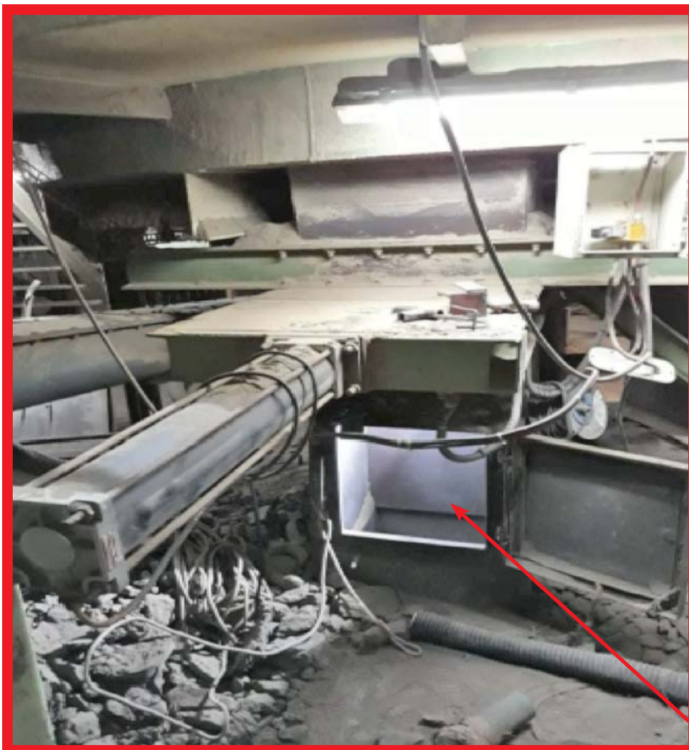
31 października 2017r.: Pracownik wykonawcy podczas czyszczenia wszedł do zesypu. W wyniku błędu zasypa nad jego głową została otwarta, co spowodowało jego zasypanie, a w konsekwencji śmierć pracownika.
