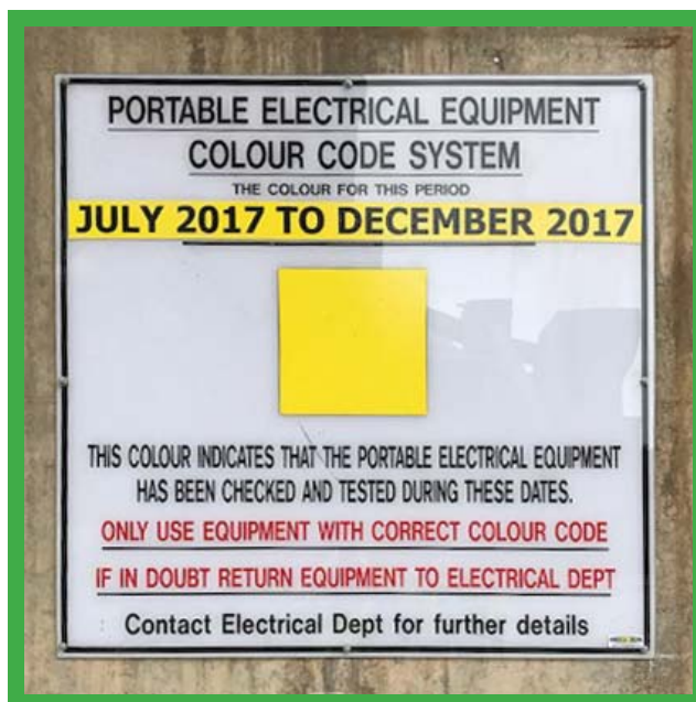
Instrukcje dla wszystkich użytkowników elektronarzędzi, aby używać tylko sprzętu z odpowiednim kolorem dla danego okresu (w systemie oznaczania kolorami).
