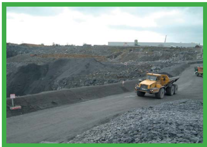
Praktyczny przykład obwałowania zabezpieczającego.
