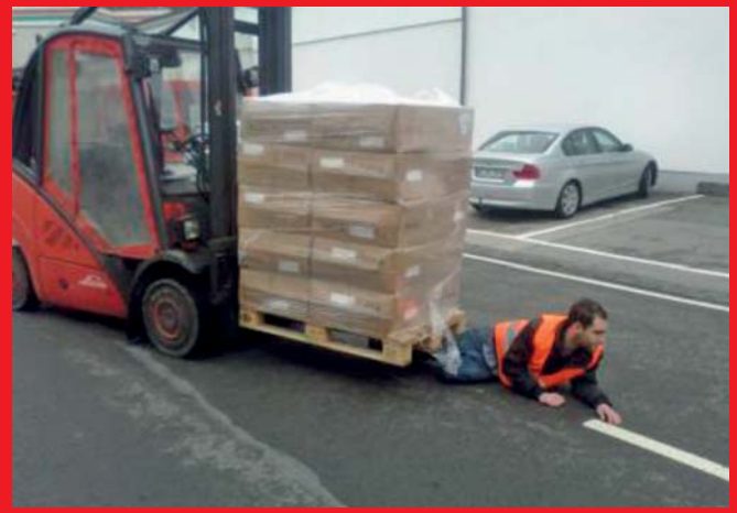
Rekonstrukcja z wypadku ciężkiego – marzec 2015 r.: Pracownik został uderzony przez jadący do przodu wózek widłowy. Pole widzenia kierowcy wózka było ograniczone przez ładunek.
