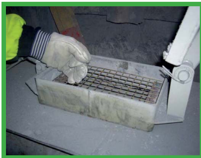
Przykład zabezpieczonego kratką otworu rewizyjnego w przenośniku ślimakowym.
