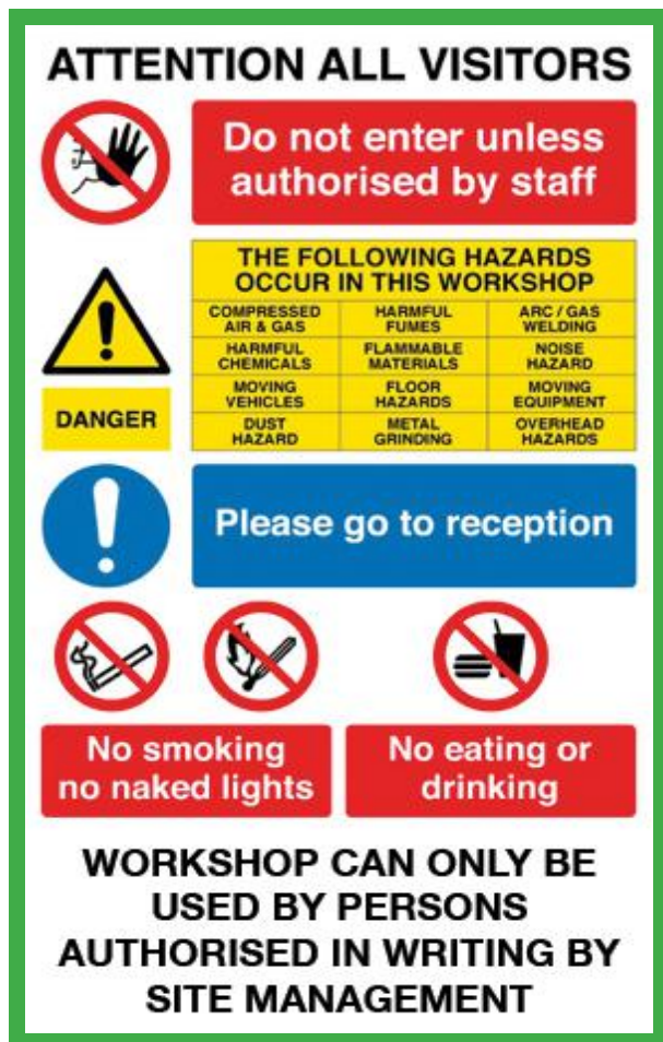
Tablica taka jak ta, odpowiadająca wymogom lokalnie obowiązujących przepisów prawnych, musi znajdować się przed zakładowymi warsztatami/miejscami konserwacji i napraw pojazdów.
