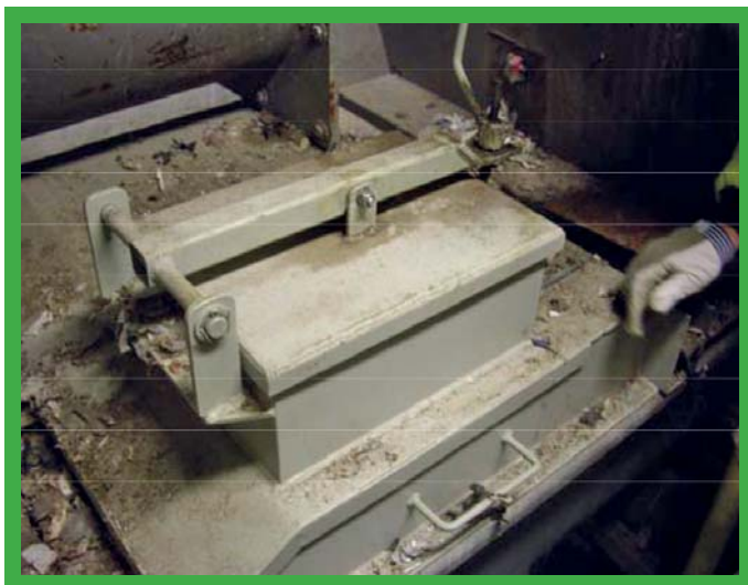
Przykład zabezpieczonego kratką otworu rewizyjnego w przenośniku ślimakowym.
