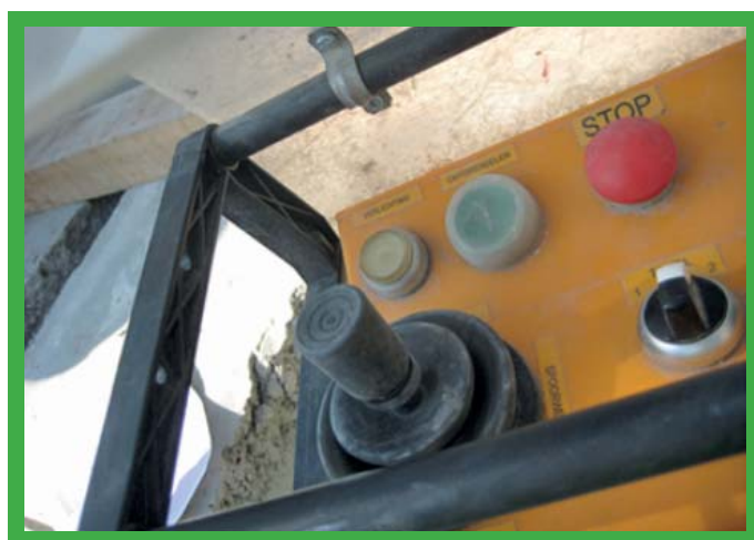
Kasety sterownicze z mechanizmem zabezpieczającym. Aby aktywować joystick, należy go wcisnąć.
