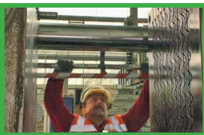
Zabezpieczenie mechaniczne – blokada zabezpieczająca przesuwne drzwi (blokada mechaniczna + kłódka).
