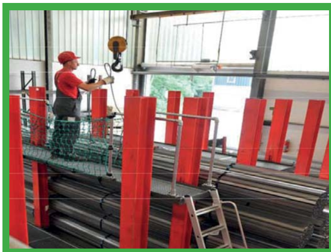
Bezpieczny dostęp do haka w celu podwieszenia na nim ładunku.
