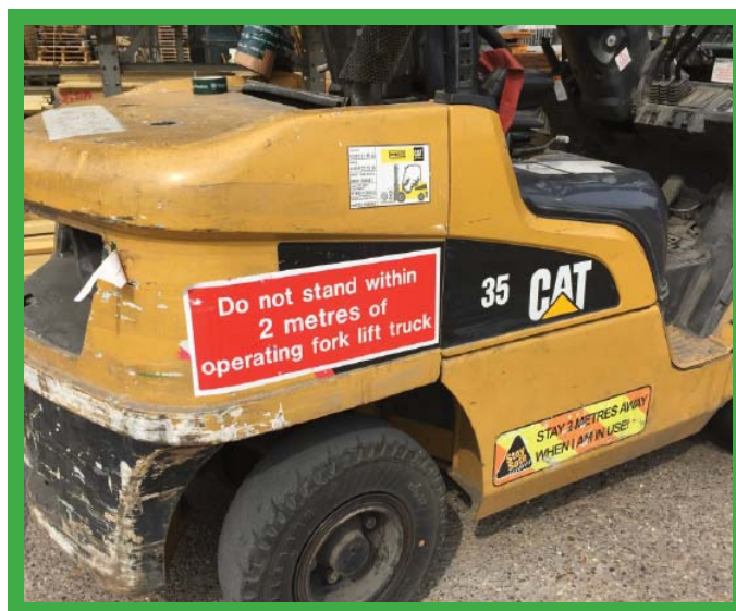
Zasada 2 metrów – wyraźna tablica ostrzegawcza umieszczona na pojeździe – „Nie zbliżać się na odległość mniejszą niż 2 metry od pojazdu”.
